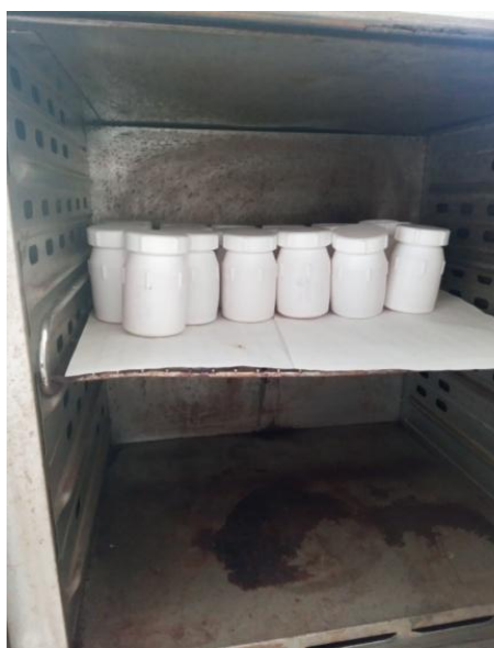
Figure II.19 : Digestion à chaud des échantillons des sédiments dans de l'acide
