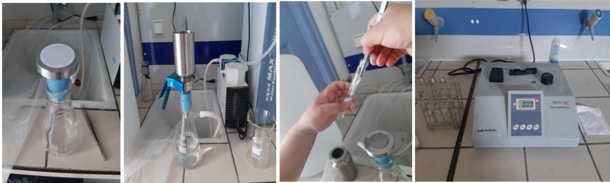
Figure 11. Etapes d'extraction et dosage de la chl a de l'eau de la mer.
