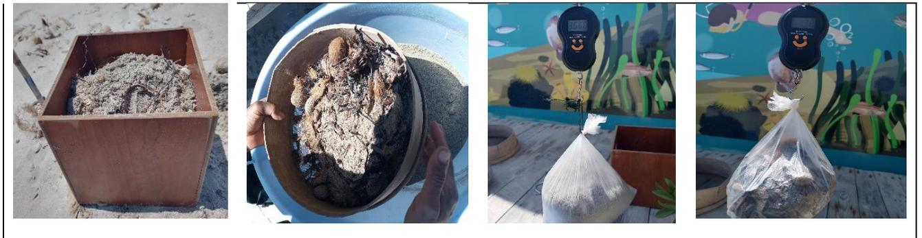
Figure 24: Etapes de quantification de la teneur en sable et des banquettes de posidonie pour la technique de MF à 4 couches
