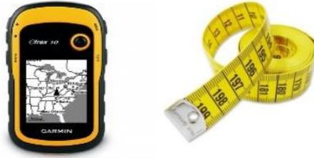
**Figure 17 : Matériel de géolocalisation (GPS mobile) et mensuration (Mètre ruban)**
